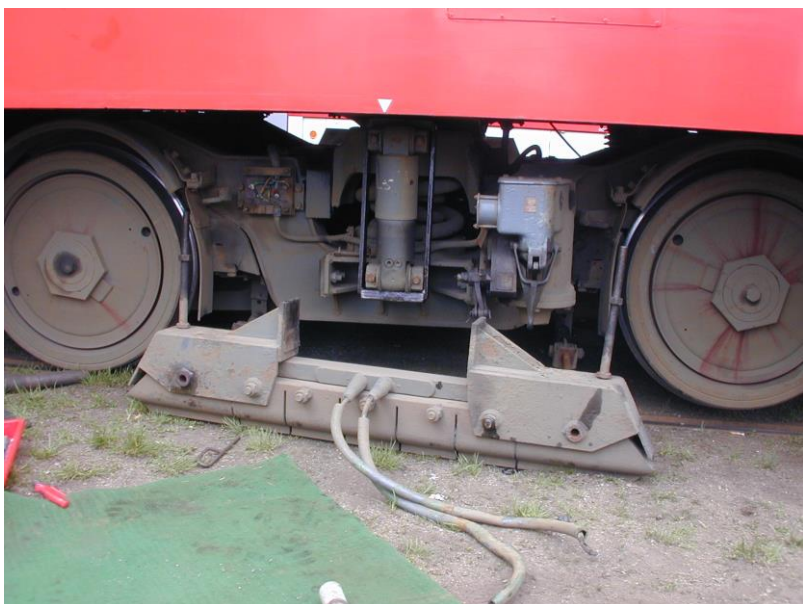
2.4 Vyjmutí kolejnicové brzdy při přizvednutí tramvaji
