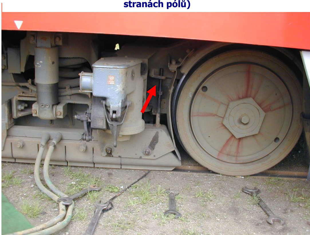
2.3 Povolení závěsů kolejnicových brzd (na obou stranách pólů)
