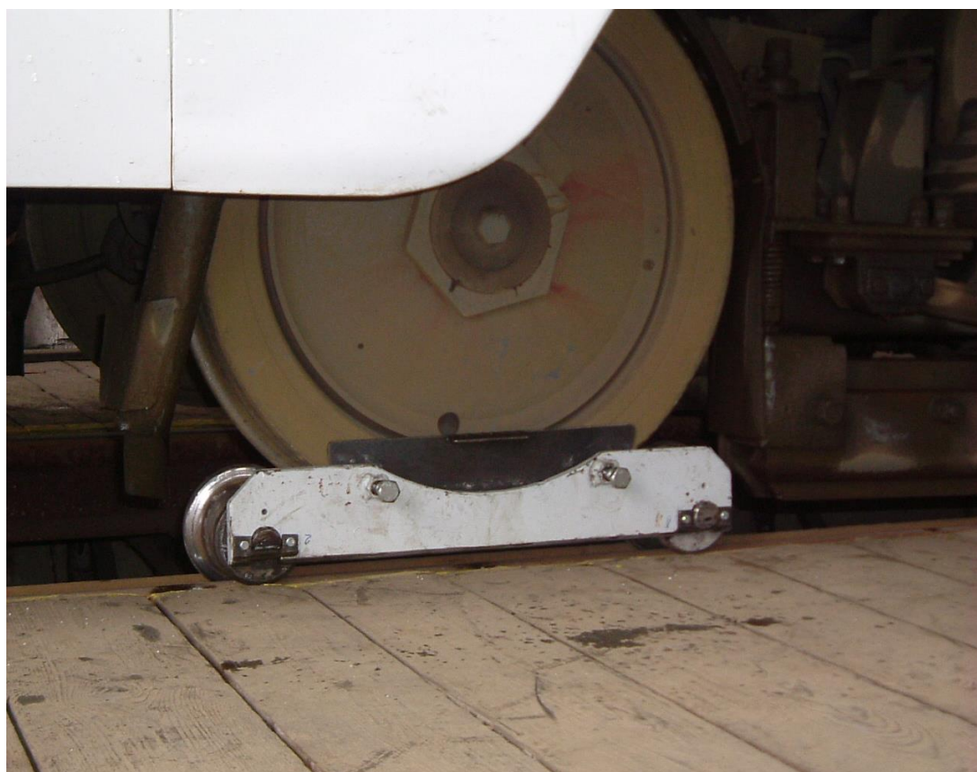
1.6 Pomocný podvozek připraven k jízdě Maximální rychlost jízdy s pomocným podvozkem do 5 km/hod.
