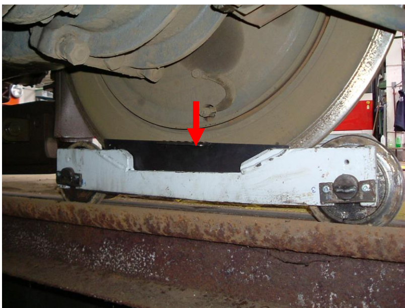
1.3 Zasunutí vymežovací podložky
